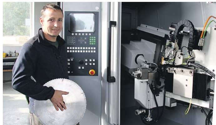
„To je naše nové CNC brousící centrum Vollmer,“ ukázal nám Radek Touš nejmodernější zařízení.
